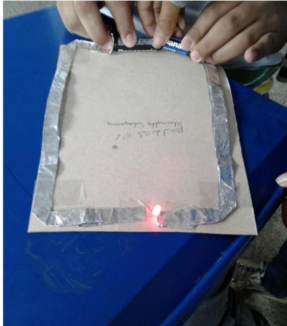
Figura 2. Circuito elétrico realizado em dupla.
